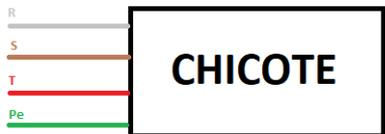
Se o forno for trifásico 220 V deve ser utilizado um disjuntor trifásico. Conecte os fios da seguinte forma: os 3 fases no disjuntor e o fio terra diretamente ao aterramento da rede (caso não o tenha, providenciar conforme NBR 5410).
